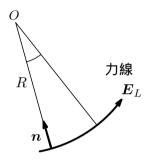
R を力線の曲率半径とすると  $E_L$  の曲率中心方向の傾きは
