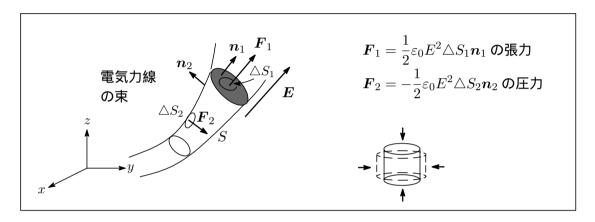
いま,電気力線の束の一部を考え,断面と側面に作用する応力を調べてみよう。電場 E と直交する等電位面上の微小面を  $\triangle S_1$  とする。電場は断面の法線ベクトル  $n_1$  と平行になるので,単位ベクトルを i,j,k とすると, $E=En_1=En_{1x}i+En_{1y}j+En_{1z}k$  と表すことができ,微小面  $\triangle S_1$  に作用する力の x 成分は (3.17) と (3.19) より
