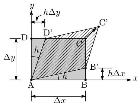
この結果，辺 AB は反時計方向に移動して AB' に，辺 AD は時計方向に移動して AD' に，対角線 AC は AC' に伸長し，流体粒子の形状は長方形を平行四辺形にひしゃげる変
