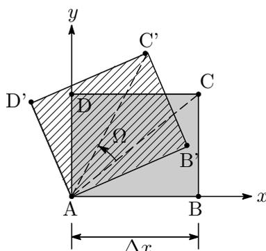
この場合、流体粒子は形状を変えずに紙面に垂直な軸の回りに角速度  $\Omega$  で反時計方向に回転していることになります。
