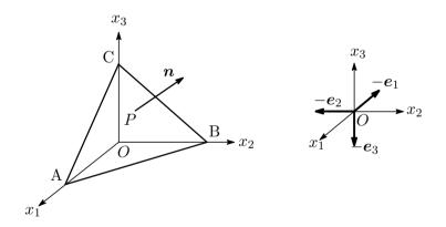
四面体の各面  $\triangle$ ABC,  $\triangle$ OBC,  $\triangle$ OCA,  $\triangle$ OAB の面積をそれぞれ  $\triangle S$ ,  $\triangle S_1$ ,  $\triangle S_2$ ,  $\triangle S_3$  とし,それぞれの面の外向き法線ベクトルを n,  $-e_1$ ,  $-e_2$ ,  $-e_3$  とする. $\triangle S_1$ ,  $\triangle S_2$ ,  $\triangle S_3$  は  $\triangle S$  の各座標平面上への正射影の面積となるので
