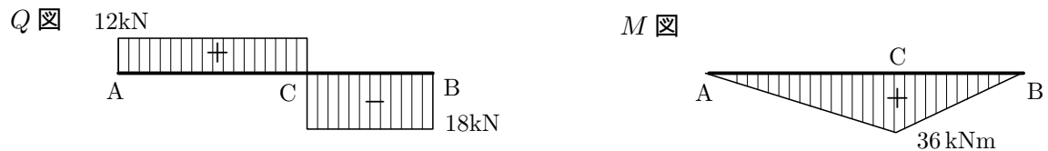
図 2.3: 単純梁の Q 図・ M 図
