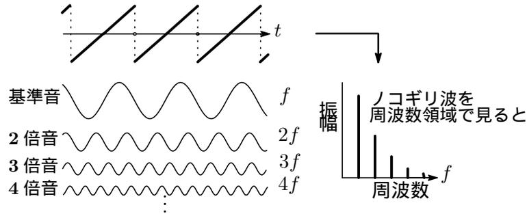
**ノコギリ波** ノコギリの形をした波形です。全ての整数倍音と呼ばれる音の成分を持った波形で、バイオリンなどの弦楽器、トランペットなどの管楽器を作るのに適しています。プラス、ストリングス、リード、ベースなど色々な音色に使えます。
