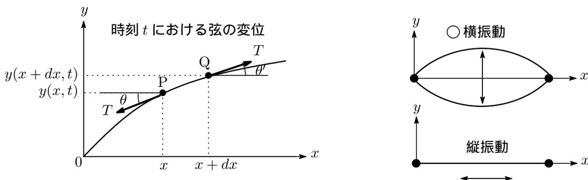
弦の張力は弦の接線方向に向いているので，弦の微小部分 PQ に働く力の  $y$  方向の成分  $F_y$  は
